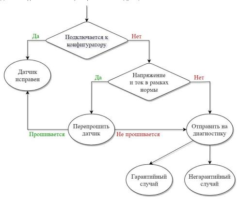
1. В первую очередь необходимо подключить датчик к компьютеру с помощью преобразователя интерфейса USB – RS-485. Датчик должен определиться в программе-конфигураторе.
