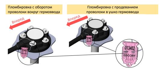
Для пломбировки датчика и кабеля используется:
