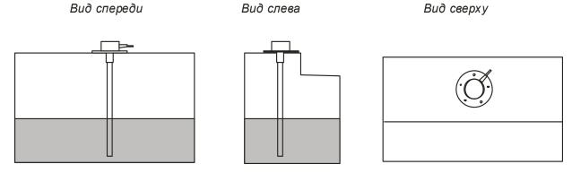
Для повышения точности и уменьшения колебаний уровня устанавливают два датчика в один бак. В основном данное решение применяется в баках емкостью более 600 литров и имеющих высоту от 1500 мм. Датчики нельзя устанавливать вплотную к стенкам бака.
