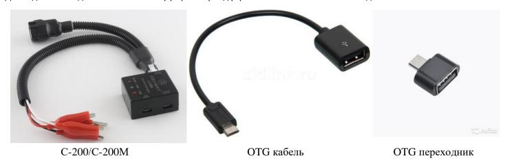
Подключите ОТG кабель (или переходник) к мобильному устройству и C200M к ОТG кабелю (переходнику).
