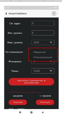
4) Выбор уровня фильтрации (для умного типа фильтрации). Есть возможность выбрать уровень фильтрации от 1 до 15. Ниже приведена таблица рекомендуемых значений фильтрации.
