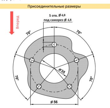
\* Даны диаметры отверстий под саморезы, при необходимости разметить по центрам указанных отверстий места под другой крепёж (ТД-100, ТД-150, ТД-500, ТД-600)
