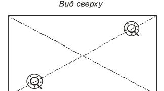
Установленный датчик должен находится на расстоянии не менее 20 мм от ребер жёсткости, перегородок, поверхностей оборудования, размещённого в баке.
