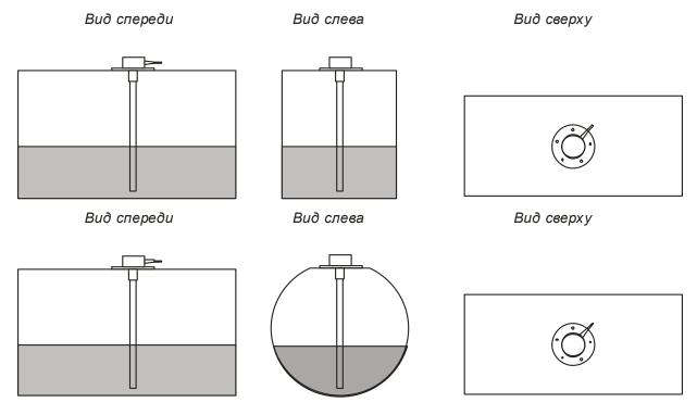
В том случае если бак имеет неправильную геометрическую форму, датчик необходимо устанавливать в месте максимальной глубины бака ближе к геометрическому центру.
