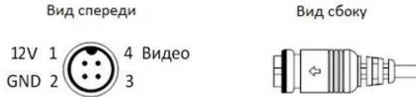
Рисунок 2 – Авиационный разъём
